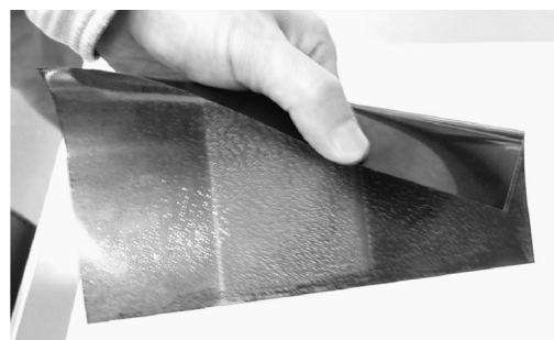
図3 熱モードで赤、緑、青の構造色を固定したフィルム状記録表示材料
