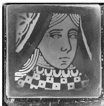
図 5 化合物 5 を添加した化合物 1 の薄膜を記録表示材料として、走査露光装置を用いて記録した安定なカラーイメージ
